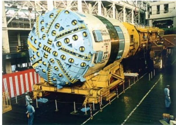
Figura 20 – TBM (Tunnel Boring Machine) empregado na construção
